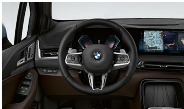
□ Il cambio automatico Steptronic a 7 rapporti con paddle al volante combina cambi marcia sportivi con grande efficienza e migliore comfort di guida. Con i paddle al volante è possibile cambiare marcia direttamente senza togliere le mani dal volante. Una soluzione ergonomica che garantisce massima sicurezza.
