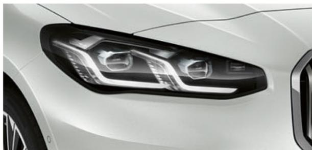
□ I fari a LED adattivi con design a quattro occhi sono dotati di funzione di illuminazione dinamica e dell'High-Beam Assistant antiabbagliamento.
