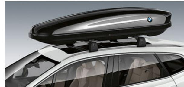
o Il moderno box per tetto BMW in nero con mascherine laterali in Titanium Silver dispone di una capacità di 420 litri ed è idoneo a tutti i sistemi portapacchi per tetto BMW. Grazie all'innovativo sistema di apertura con chiusura centralizzata a tre punti su entrambi i lati è facilmente caricabile e assicura una chiusura contro i furti.
