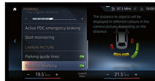
□ Oltre al Parking Assistant<sup>2</sup>, il dispositivo di assistenza al parcheggio Parking Assistant Plus dispone di più telecamere e visualizza anche in 3D l'ambiente circostante la vettura. Ciò facilita il controllo delle manovre.
