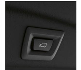
L'attivazione automatica del portellone posteriore permette di aprire e chiudere elettricamente il portellone, premendo semplicemente un pulsante.
