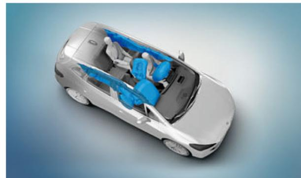
Gli airbag per guidatore e passeggero anteriore, gli airbag laterali integrati negli schienali dei sedili anteriori e gli airbag per la testa per tutti e quattro i posti esterni, integrati nella barra di supporto del tetto e nel montante anteriore fanno parte degli elementi per la massima sicurezza presenti in ogni BMW e offrono protezione mirata in caso di emergenza.
