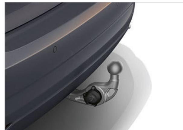
Il gancio di traino con testa sferica orientabile elettricamente dispone di una funzione di controllo della stabilizzazione del rimorchio e di un attacco antifurto.
