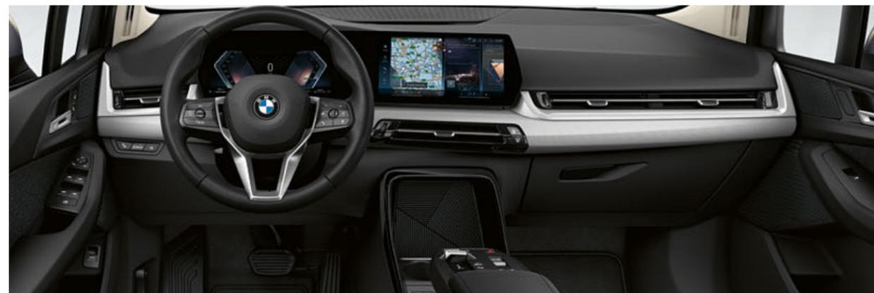
■ Il BMW Live Cockpit Plus comprende il display combinato curvo, che include un display strumenti da 10,25" e un Control Display Touch da 10,7".
