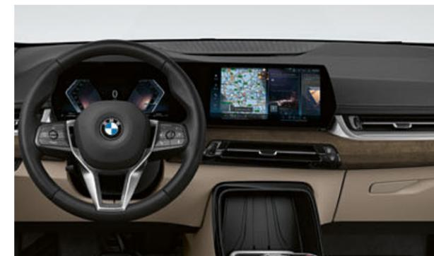
■ Il BMW Curved Display associa l'utilizzo intuitivo a un sistema di visualizzazione digitale composto da un display strumenti da 10,25" e un Control Display da 10,7".
