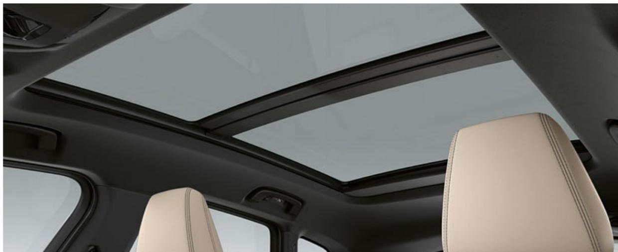
□ Tettuccio panoramico in vetro ad azionamento elettrico, scorrevole / inclinabile, con tendina parasole avvolgibile, deflettore antivento e apertura e chiusura comfort tramite la chiave della vettura.
