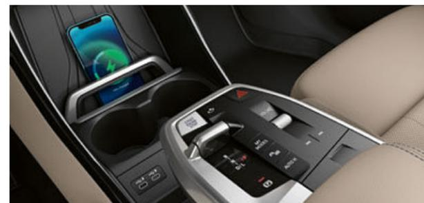
□ Il vassoio di ricarica wireless permette la ricarica induttiva di dispositivi mobili che supportano questa funzione.
